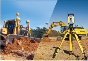
Das 3D-System eignet sich besonders für Massenaushub-Anwendungen und die Erstellung von komplexen Geländegeometrien wie
