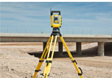
Bau-Tachymeter ermöglichen Ihnen die bestmögliche Kontrolle über den Bauplan. Sie können z.B. Ihren Plan mit Hilfe von Referenzpunkten erstellen, an einer Baugrenze ausrichten und die Punkte wieder in die Örtlichkeit übertragen.
