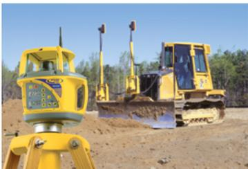
Der 2-Neigungslaser für die Maschinensteuerung gibt die Soll-Höhe und -Querneigung für die Laserempfänger vor. Durch die hohe Genauigkeit, die große Laserreichweite und die einfache Bedienung bietet unser 2-Neigungslaser eine zuverlässige und sehr effiziente Möglichkeit zur automatischen Schildsteuerung in Verbindung mit Laserempfängern.
