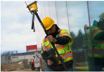
Der GNSS-Rover erfüllt mit seiner hohen Genauigkeit die Anforderungen für Baustellenpositionierung und Basisstation hervorragend.
