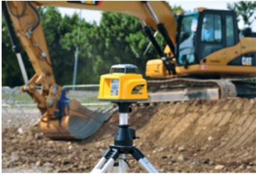
Leistungsstarke 2-Neigungslaser mit automatischer Nivellierung. Einfache und genaue Neigungseingabe. Alle unsere 2-Neigungslaser sind auch für große Entfernungen bis 800 m Durchmesser einsetzbar. Funktionen für Nivellier-, Neigungs- und Ausrichtarbeiten.
