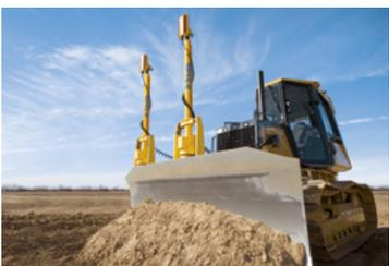
Die Dual-Lasersteuerungen sind extrem flexible Systeme für Querneigungs- und Höhensteuerung für Raupen und Grader. Sie ermöglichen die Höhenreferenzierung über Laser oder Ultraschall sowie die Querneigungssteuerung über eine Sensor- oder Zweimastlösung.
