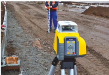
Der Vollautomatische, selbstnivellierende Horizontal-/Vertikallaser mit Zweistrahlprisma ist für eine Vielzahl von horizontalen, vertikalen und Lot-Anwendungen geeignet.
