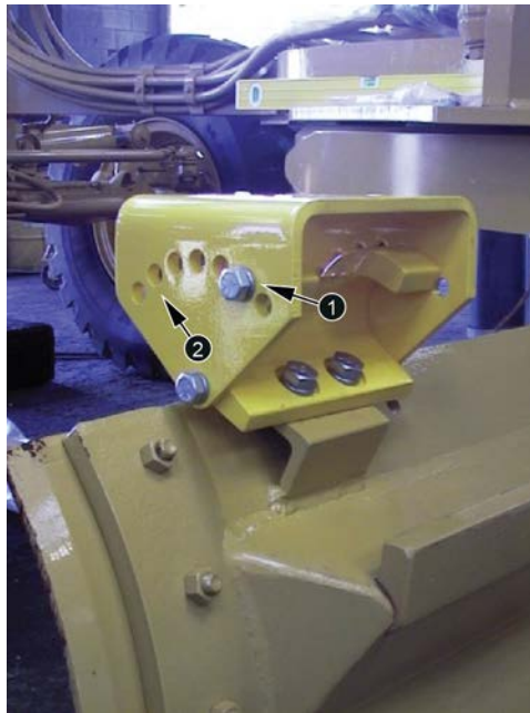
Abbildung 3.1 Masthalterung für drehbaren Mast am Motorgrader
