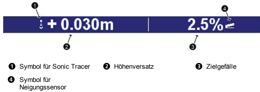
Abbildung 2.3 Beispiel für einen Bereich mit Führungseinstellungen für ein mit Sonic Tracer geführtes System „Heben + Querneigung“
