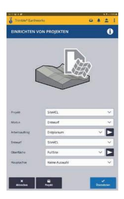
In Trimble Earthworks gibt es keine einzelnen Entwürfe. Alle Entwürfe, egal ob 2D oder 3D, sind in einem Projekt gespeichert. Um einen Entwurf auszuwählen, muss man zuerst das jeweilige Projekt wählen. Im Menü **Modus** kann man von einem Entwurf (3D) in den Tiefen- und Neigungsmodus (2D, 2,5D) oder in vor Ort Entwürfe (2,5D) wechseln. Ein Arbeiten ist hier auch ohne 3D Entwurfsdaten möglich.
