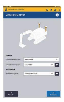
Über **Positionierungsquelle** kann man die gewünschten Sensoren für die Positionierung auswählen. Zur Auswahl steht Dual GNSS,GNSS links, GNSS rechts, UTS links, UTS rechts und 2D.
