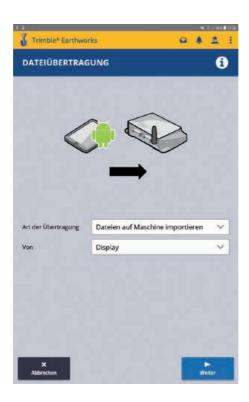
Die Datenübertragung kann manuell oder über das Einstecken eines Sticks in das TD520 aufgerufen werden. Daten können zu einem USB Stick, zum Display oder zur Trimble Connected Community übertragen werden.
