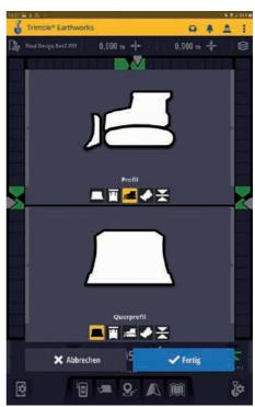
Sie haben die Auswahl zwischen 3D Ansicht, Kartenansicht, Längsprofi I der Maschine, Querprofi I der Maschine, Auftrag / Abtrag und der Libellenanzeige (beim Bagger).
