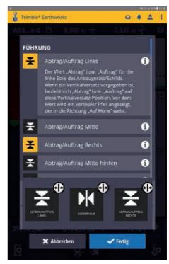
Durch langes Tippen auf das **Textband** (oder Aufruf über die Systemeinstellungen) erscheint ein Auswahlmenü. In Auswahlmenü kann der Inhalt des Textfeldes bestimmt werden. Tippen Sie hierzu auf das gewünschte Element. Das gewählte Element wird hinten angefügt.
