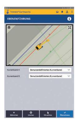
Durch langes Drücken auf die Taste **Ebenenführung** kommt man in das Auswahlmenü. Hier kann man eine Hauptachse wählen oder ändern und von Hand die Linien für die Ebenenführung wählen.
