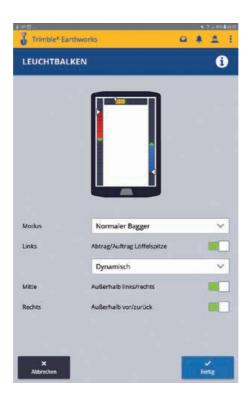
Sofern keine externen Leuchtbalken verbaut wurden, können im Display Leuchtbalken angezeigt werden. Die einzelnen, digitalen Leuchtbalken können in der Software ein und ausgeblendet werden.
