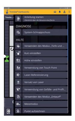
Mit einem **System-Schnappschuss** können alle relevanten Maschinendaten auf einmal gesichert werden. Einfach oben rechts auf die drei Punkte und im Untermenü auf **System-Schnappschuss** tippen. Die Daten können nun über die **Dateiübertragung** (Seite 24) mit einem USB Stick oder der Trimble Connected Community vom Rechner geladen werden.
