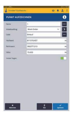
Über **Punkt aufzeichnen** können einzelne Punkte mit Code (Beschreibung) in **einem Arbeitsauftrag abgespeichert werden**. Die verwendeten Codes werden in einer Liste gespeichert und können immer wieder in diesem Projekt abgerufen werden. Wenn eine Codebibliothek (\*.fxl Datei) hinterlegt ist, können diese Codes zur Beschreibung der Punkte genutzt werden.
